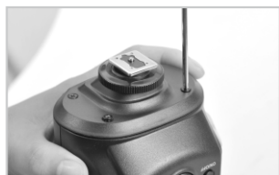
1. 用螺丝刀(本产品不配)将AD360II-C底部的四个螺丝拧松，小心取下机身底部的部件。
